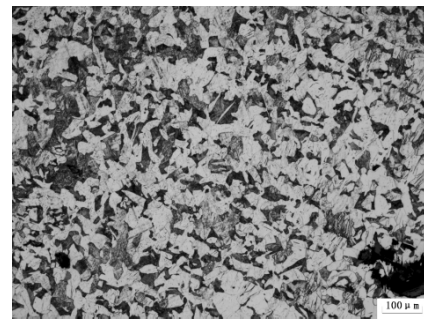
图五 T1118⑥:1,锤,西汉中后期,铁素体+珠光体组织的亚共析钢冷锻组织,含碳量约为0.4%,铸铁脱碳钢。
